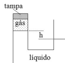
Após uma expansão volumétrica do gás, e ainda mantendo a pressão final da amostra de gás ( $p_{gf}$ ) menor do que a pressão atmosférica ( $p_0$ ), assinale a alternativa que indica corretamente a expressão da diferença  $p_0 - p_{gf}$  quando o líquido atingir o repouso.
